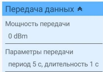
При нажатии на параметр «**Мощность передачи**» откроется дополнительное окно, где, выбрав соответствующее значение, можно увеличить или уменьшить мощность сигнала радиометки.
