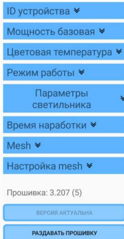
**ID устройства.** Настройка уникального идентификатора устройства используется при производстве, не рекомендуется менять ID при эксплуатации.
