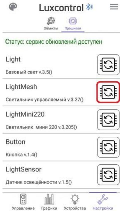
Для примера рассмотрим процесс обновления контроллера светильника (обозначается в мобильном приложении Luxcontrol как LightMesh). При нажатии на кнопку обновления откроется окно для выбора оборудования, чьё встроенное ПО можно обновить следующими способами:
