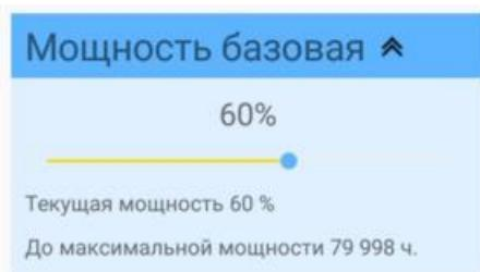
**«Текущая мощность»** светильника вычисляется как базовая мощность плюс мощность компенсации старения. При времени наработки равном нулю текущая мощность равна базовой. Текущая мощность в дальнейшем используется при управлении светильником как 100% яркости светильника, и при выводе светильника на 100% яркости он будет работать именно на текущей мощности.
