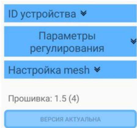
**ID устройства.** Настройка уникального идентификатора устройства используется при производстве, не рекомендуется менять ID при эксплуатации.
