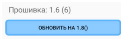
Если нажать на данную кнопку, начнётся процесс передачи ПО на устройство. Затем произойдёт обновление прошивки и, в случае успеха, появится окно с сообщением о завершении обновления встроенного ПО.
