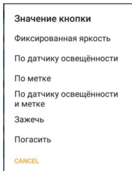
**«Фиксированная яркость»** позволяет установить фиксированный уровень яркости светильника.
