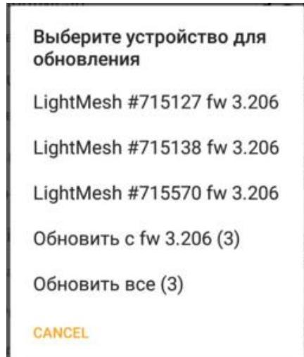
После выбора необходимого способа обновления начнётся процесс передачи прошивки на устройство. Далее произойдёт обновление прошивки и, в случае успеха, появится окно с сообщением о завершении обновления встроенного ПО.
