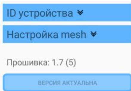
**ID устройства.** Настройка уникального идентификатора устройства используется при производстве, не рекомендуется менять ID при эксплуатации.
