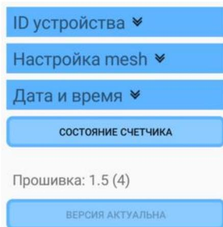
**ID устройства.** Настройка уникального идентификатора устройства используется при производстве, не рекомендуется менять ID при эксплуатации.
