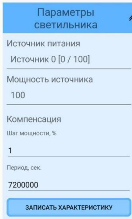
Параметр «**Источник питания**» позволяет задать настройки источника питания светодиодов. Для этого необходимо нажать на тип источника питания, и, в открывшемся меню, выбрать один из предустановленных источников, либо ввести параметры источника питания вручную, выбрав пункт «**Ручной ввод**».
