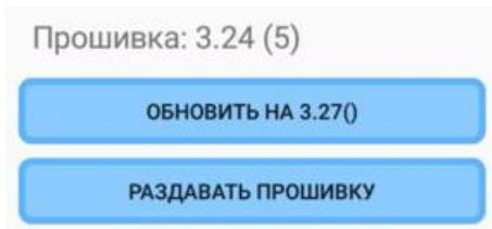
Если нажать на данную кнопку, начнётся процесс передачи ПО на устройство. Затем произойдёт обновление прошивки и, в случае успеха, появится окно с сообщением о завершении обновления встроенного ПО.
