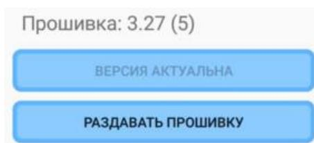
После обновления встроенного ПО на одном контроллере светильника удобно воспользоваться функцией обновления прошивки через mesh-сеть на других контроллерах светильников. Это позволяет не обновлять ПО на каждом контроллере по отдельности. Чтобы произвести массовое обновление прошивок, необходимо на контроллере с актуальной версией ПО нажать на кнопку **«Раздавать прошивку»**, после чего откроется окно, в котором нужно ввести количество попыток обновления прошивок. Рекомендуемое значение – 3.
