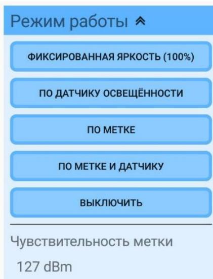
**Фиксированная яркость.** Позволяет задать фиксированное значение яркости светильника. При настройке задается значение яркости от 0 до 100%.
