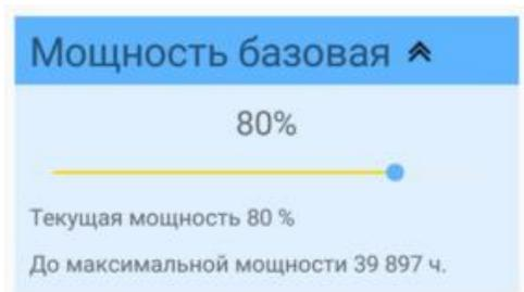
Параметр **«Мощность базовая»** предназначен для регулировки светового потока непосредственно после установки светильника, а также при необходимости для изменения световой схему в процессе эксплуатации.
