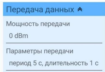
Раздел «**Передача данных**» позволяет настраивать параметры трансляции радиометкой команд и сообщений на контроллеры/мини-контроллеры светильников.
