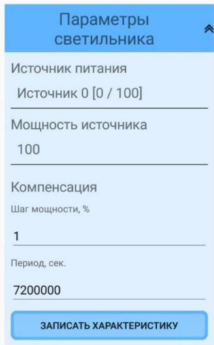
«Параметры светильника» позволяет задать параметры источника питания (LED- драйвера) и компенсации деградации.
