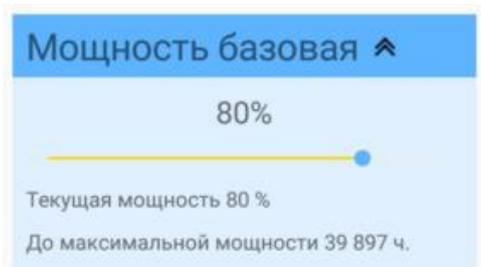
Параметр **«Мощность базовая»** предназначен для регулировки светового потока непосредственно после установки светильника, а также при необходимости для изменения световой схемы в процессе эксплуатации.
